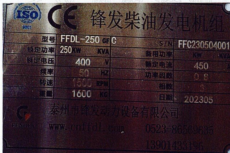
FFDL-250GFC 型通信用低压柴油发电机组样品照片
